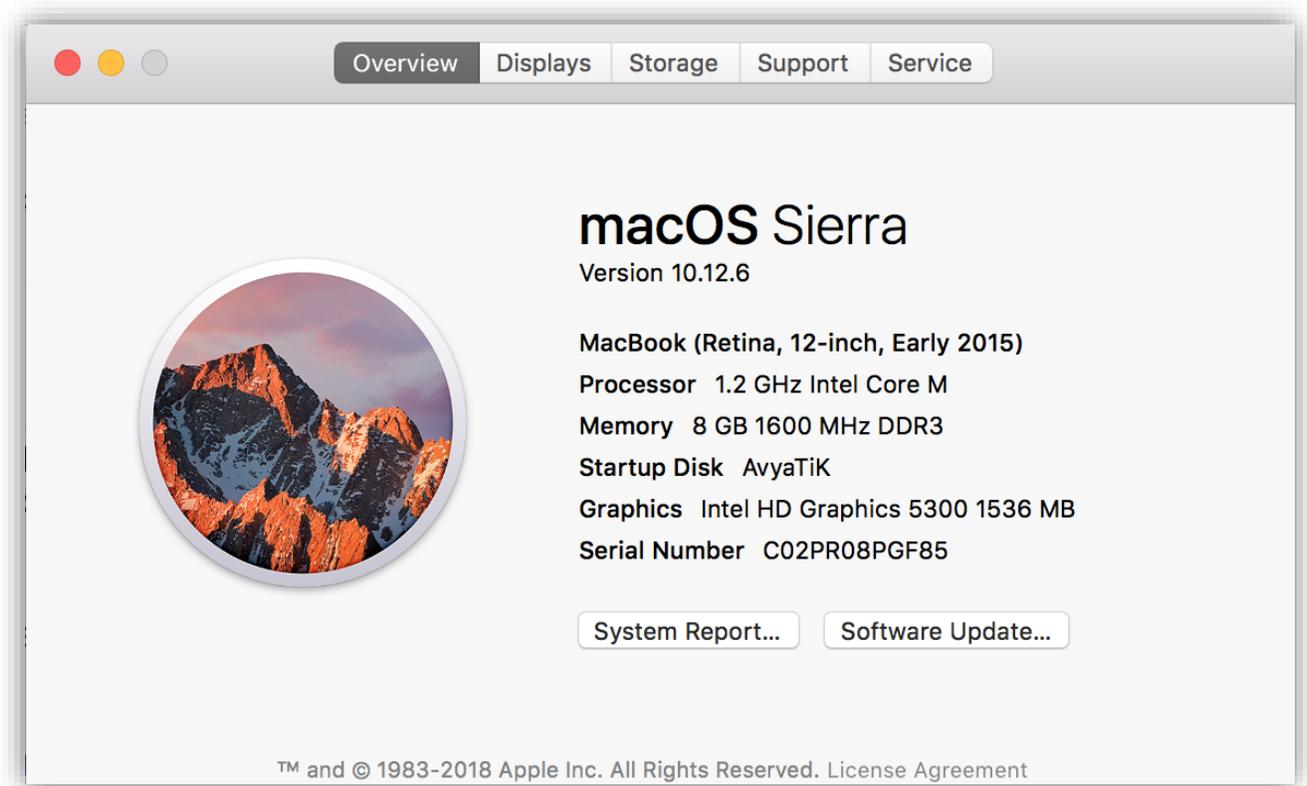
**Moins performants que les i3, i5 et i7, les Core M ont l'avantage de consommer peu d'énergie, et donc d'augmenter considérablement l'autonomie des appareils. C'est d'ailleurs le Core M qui équipe le dernier-né des portables d'Apple (9 h d'autonomie). Gardez en tête qu'un disque dur lent ralentira fortement l'impression de fluidité, même avec le plus performant des processeurs. Un disque SSD reste l'allié incontournable d'un bon processeur.**
